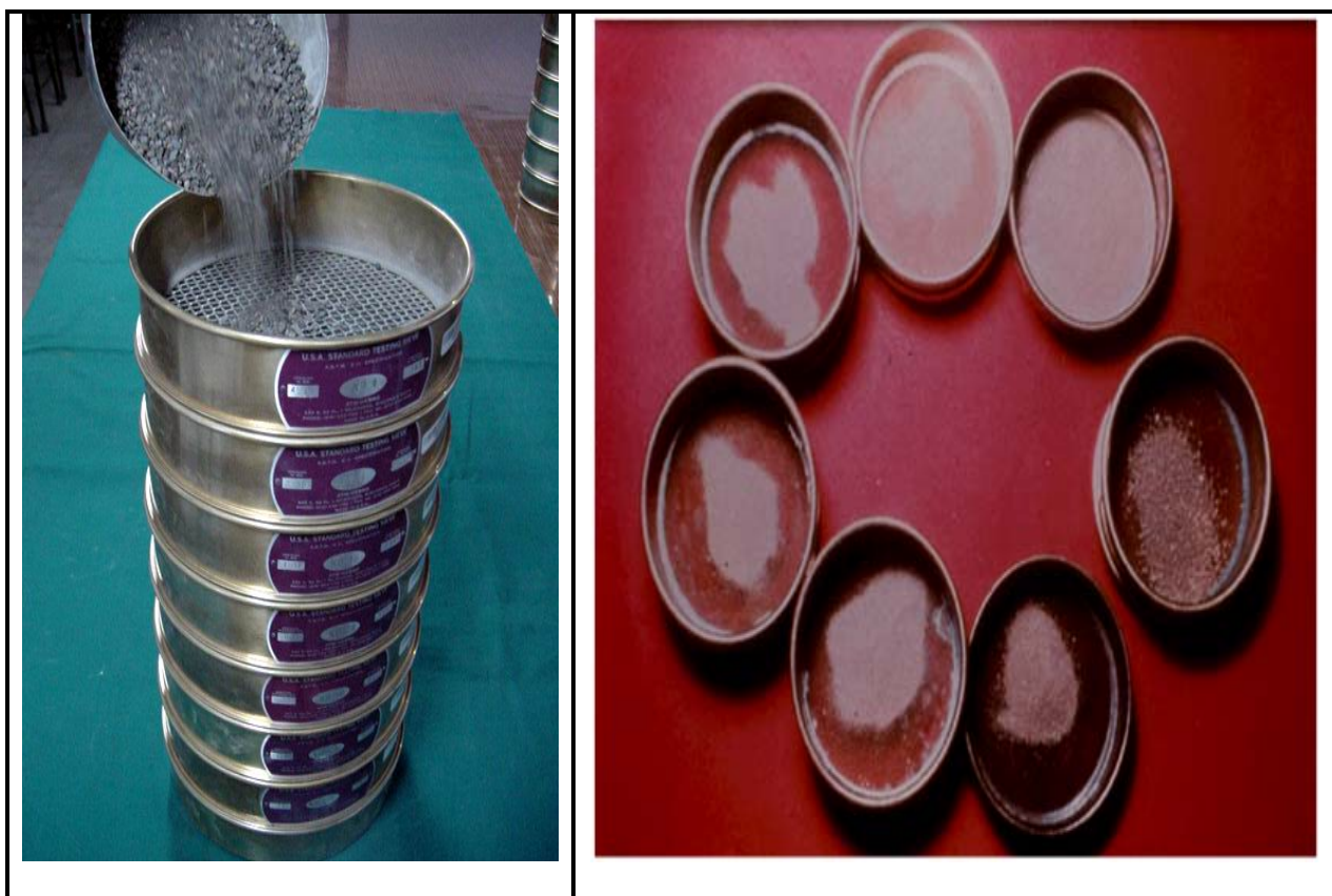
Figura 49. Proceso de tamizado, para análisis granulométrico.
