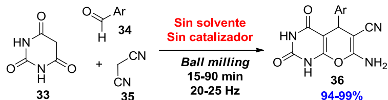
Esquema 18. Síntesis mecanoquímica de pirano [2,3- d ] pirimidin-6-carbonitrilos mediante la condensación de tres componentes en un molino de bolas.
