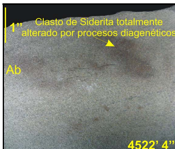
Figura 3.7. Facies Arenita bioturbada (Ab), Profundidad 4522'4"-4522'0", Pozo Tibú 408-K. Corresponde a una sublitoarenita amarillenta a grisácea.
