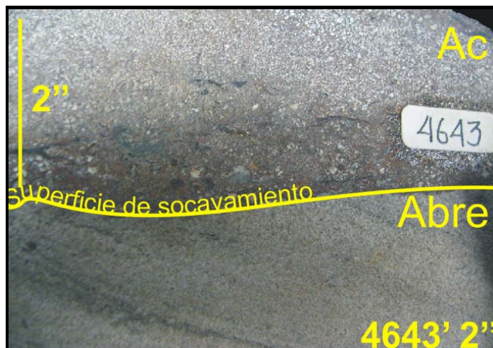
Figura 3.19. Facies Arenita con clastos (Ac), Profundidad 4643'2"-4642'11", Pozo Tibú 408-K. Corresponde a una litoarenita gris claro. Se aprecia una superficie de socavamiento que marca el límite con la infrayacente facies Abre.
