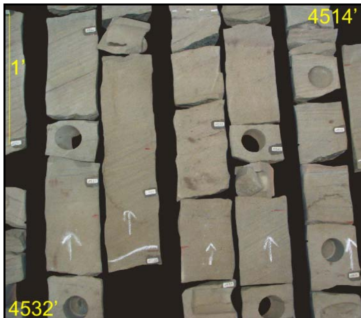
Figura 3.43. Impregnación estimada visualmente en el depósito de barra de desembocadura, Pozo Tibú 408-K - Formación Barco. Los tonos café corresponden a intervalos impregnados de hidrocarburo.
