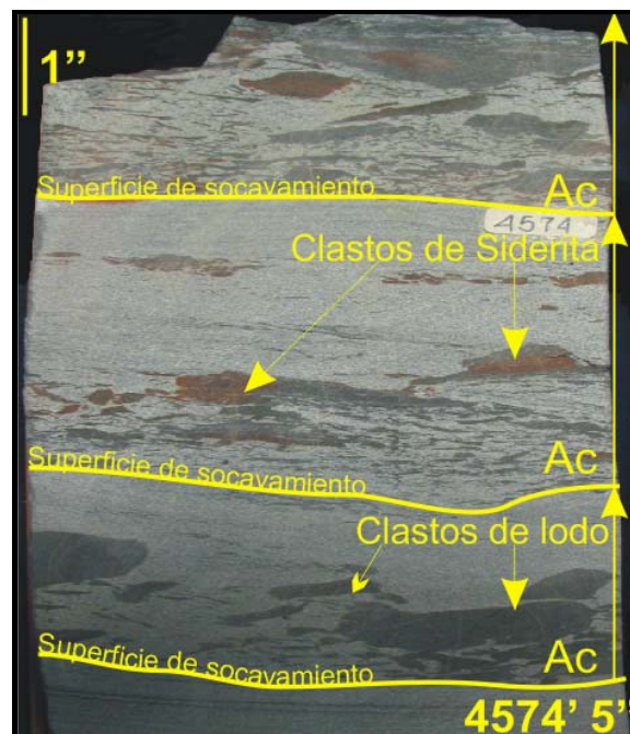
Figura 3.20. Facies Arenita con clastos (Ac), Profundidad 4574'5"-4573'10.5", Pozo Tibú 408-K. Corresponde a una litoarenita gris claro. Se aprecian varias superficies de socavamiento y clastos sideríticos y limo-arcillosos redepositados a la base de canales submareales.
