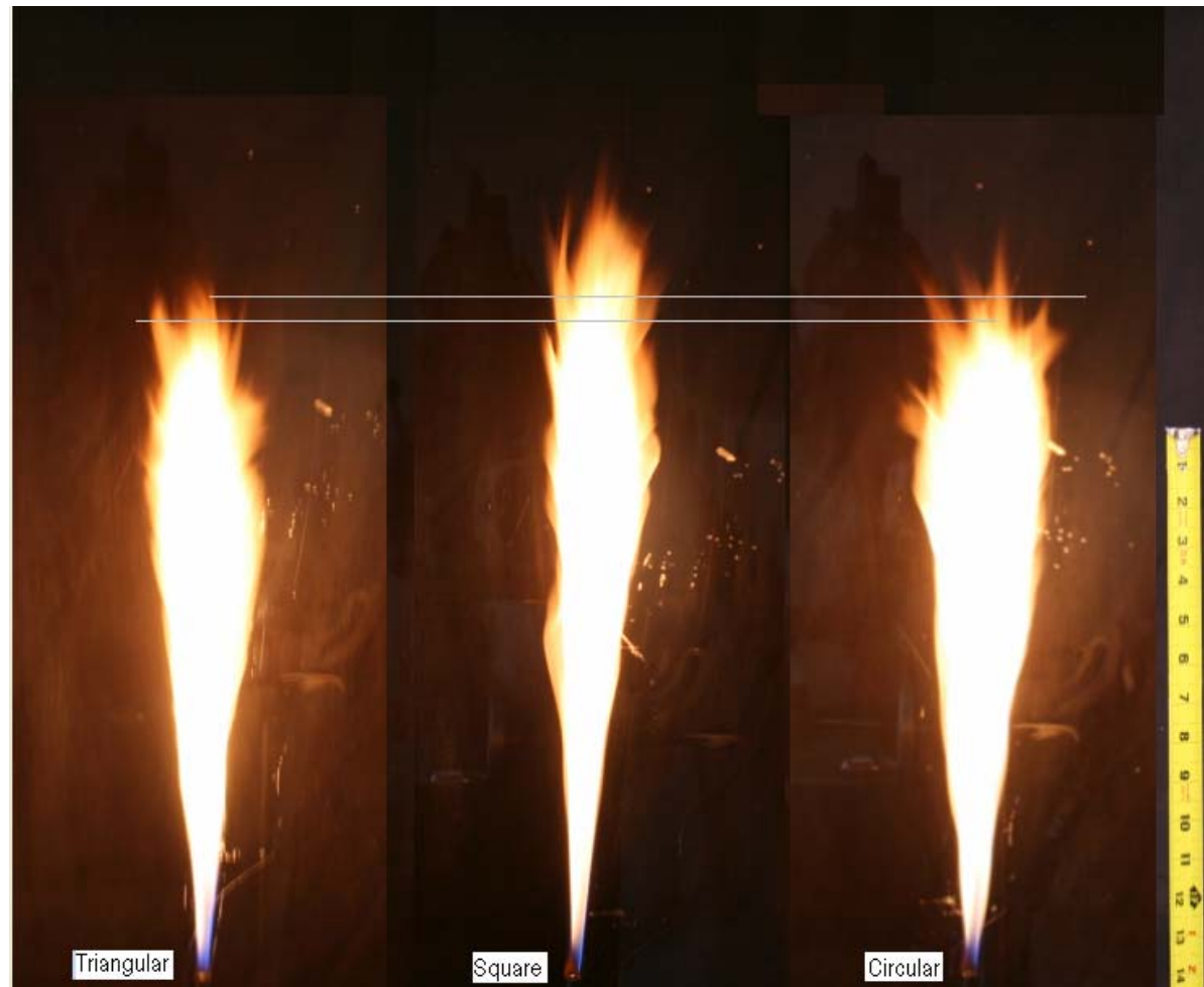
Figura 22. Fotografía de Llamas Producidas por quemadores Circular, Cuadrado y Triangular en Régimen de transición a una Velocidad de Salida de Combustible de U_{\text{exit}} = 7.87 \text{ m/s}
