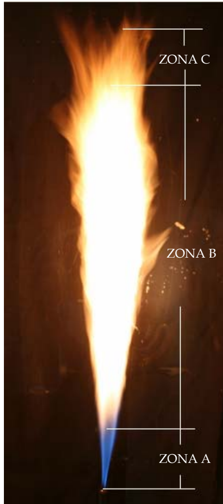
Figura 20. Estructura una llama de difusión de combustibles gaseosos.
