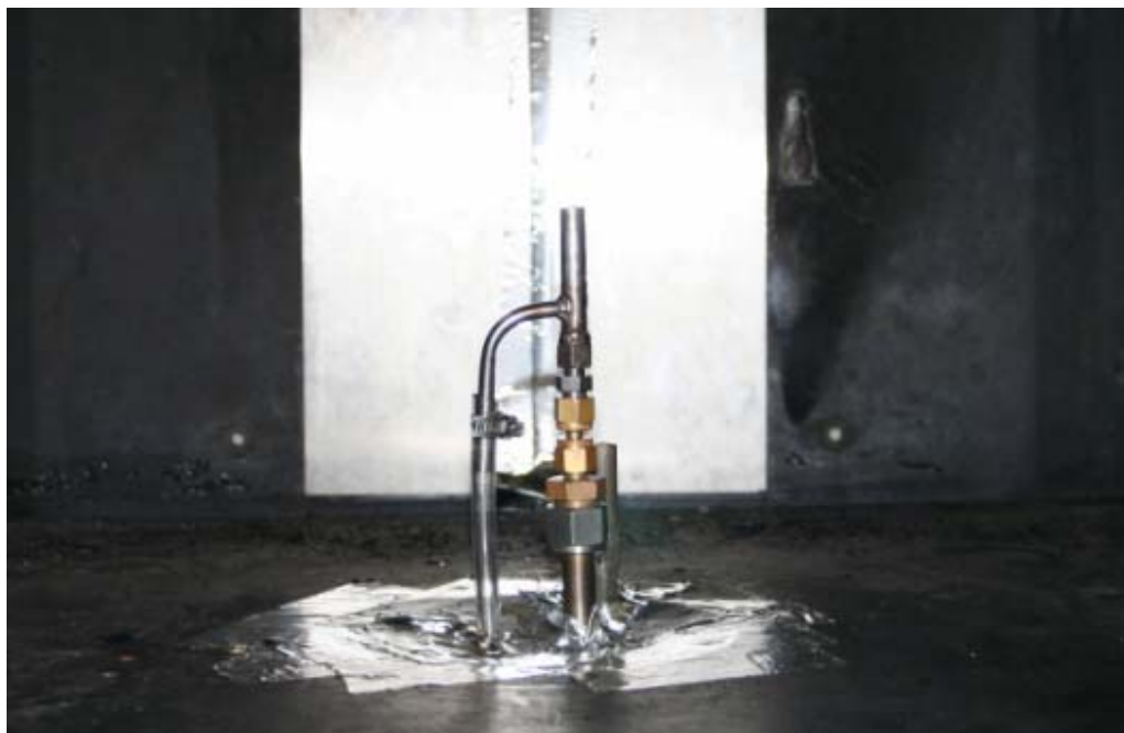
Figura 10. Fotografía del Quemador Instalado en La Cámara de Combustión
