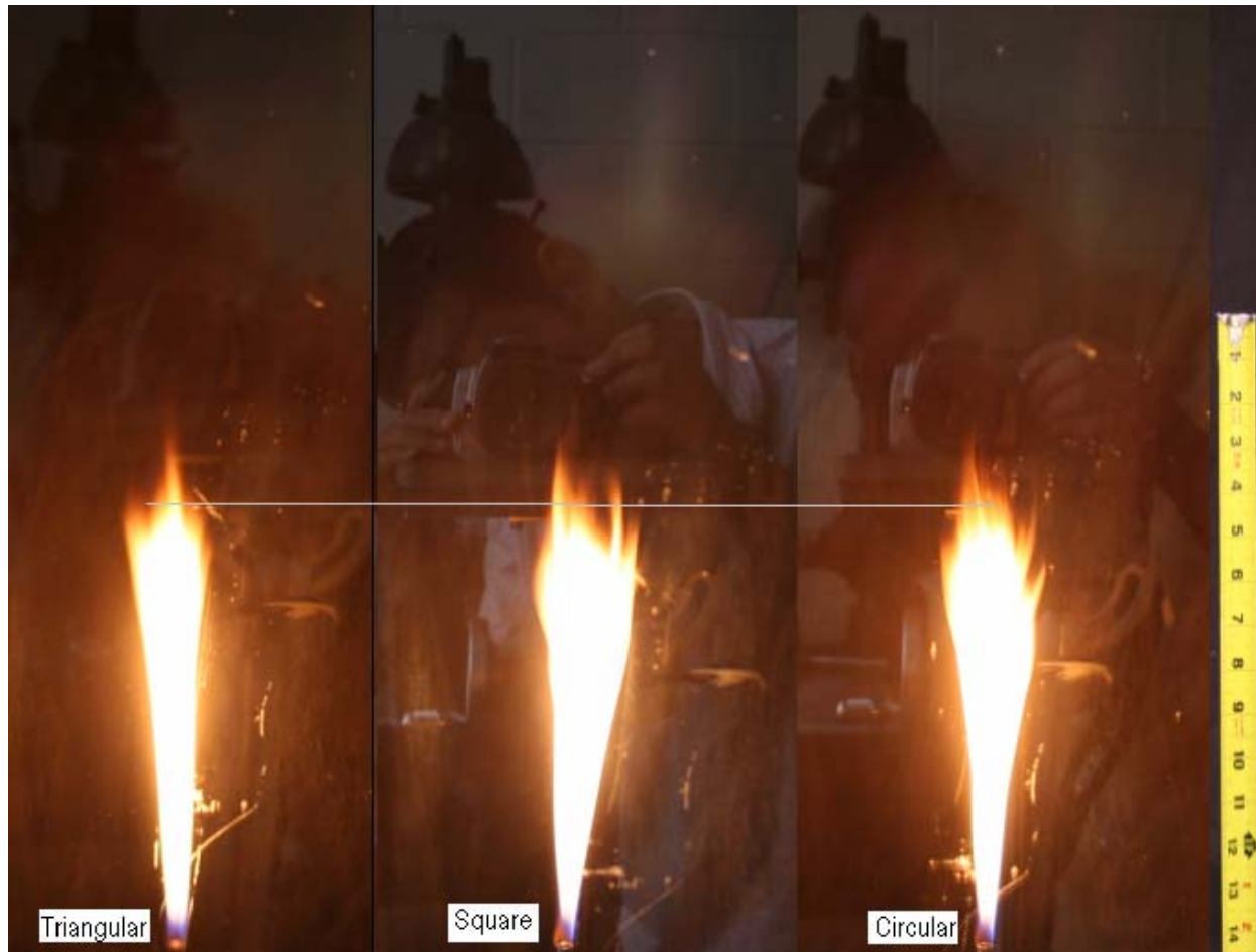
Figura 21. Fotografía de Llamas Producidas por quemadores Circular, Cuadrado y Triangular en Régimen Laminar, a una Velocidad de Salida de Combustible de U_{\text{exit}} = 2.62 \text{ m/s}
