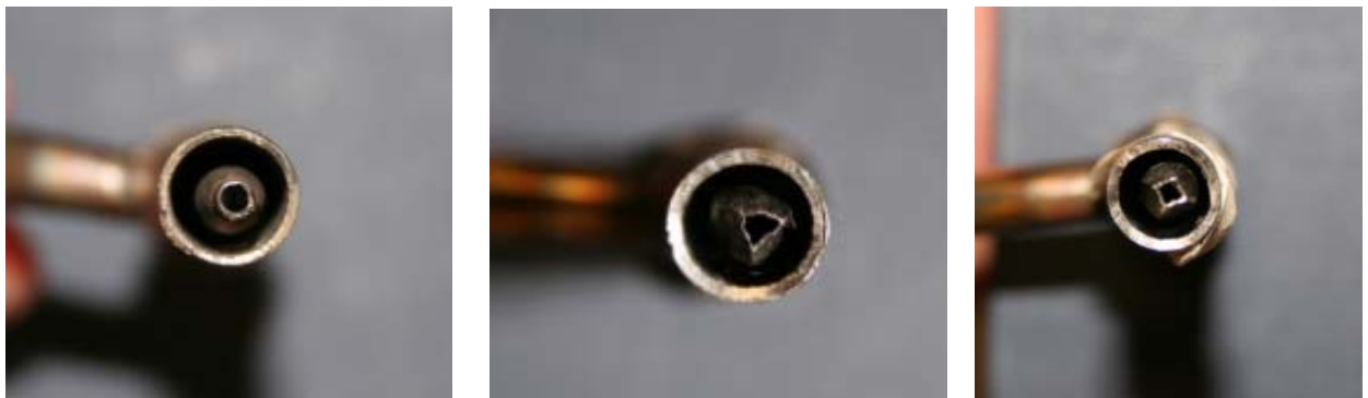
Figura 8. Fotografía de la salida los Tres Quemadores Utilizados
