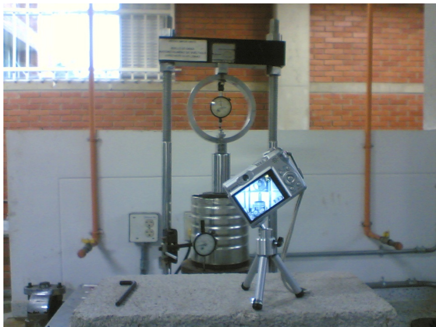
Figura 2.2. Medida del módulo de rigidez en la máquina Marshall
