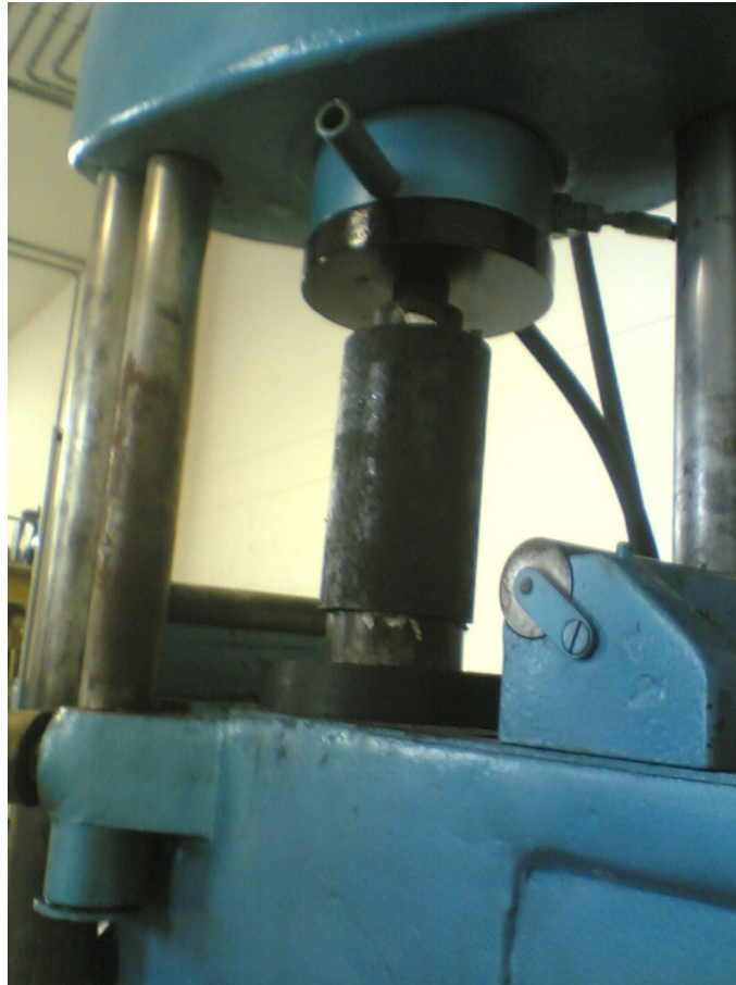
Figura 2.1. Compactación de la probeta en la máquina universal
