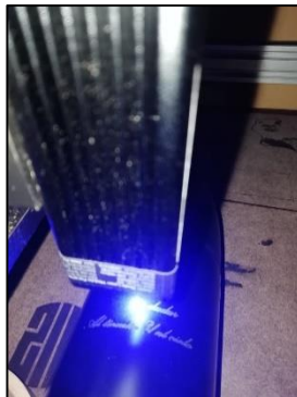
Figura 26. Proceso de grabado sobre una superficie metálica.
