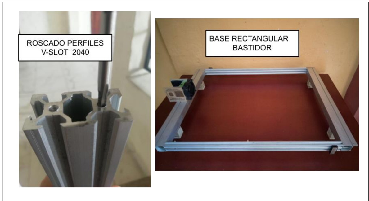
Figura 13. Roscados de perfiles de aluminio y figura de la estructura.
