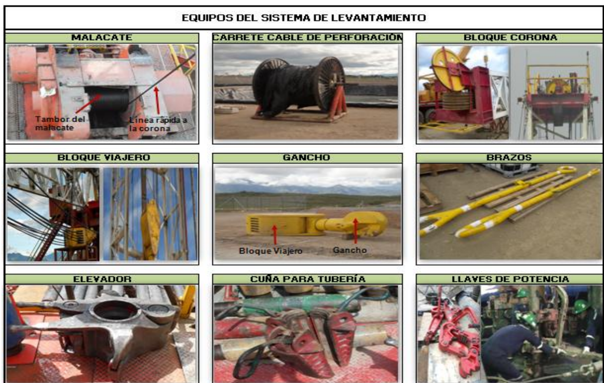
Figura 7. Equipos del sistema de levantamiento. Equipo de perforación EVSA
