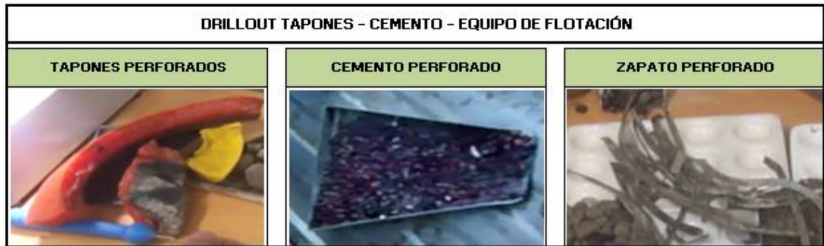
Figura 25. Drill out tapones, cemento y equipo de flotación
