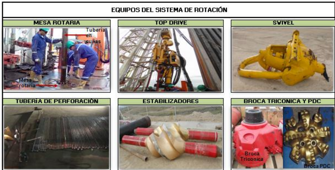
Figura 5. Equipos del sistema de rotación. Equipo de perforación EVSA
