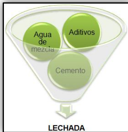
Figura 18. Componentes de la lechada de cemento
