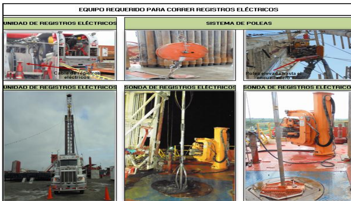
Figura 16. Equipo para correr registros eléctricos
