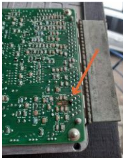
Figura 23. Transistor quemado de la ECU
