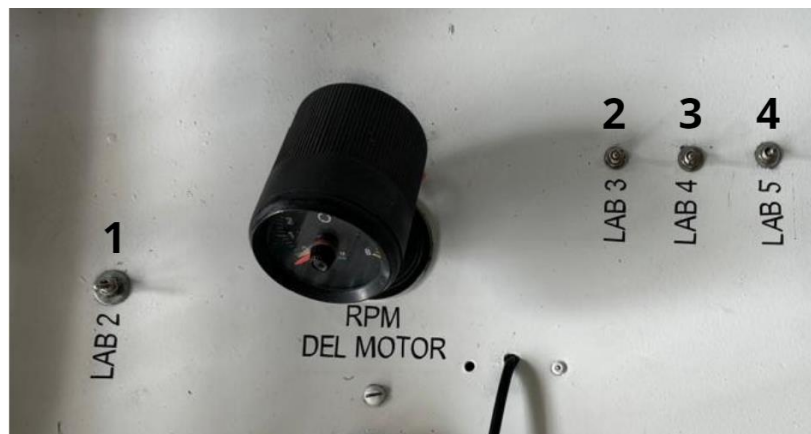
Figura 39. Identificación interruptores de falla para los laboratorios
