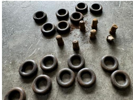
Figura 18. Orings de los inyectores antes del cambio
