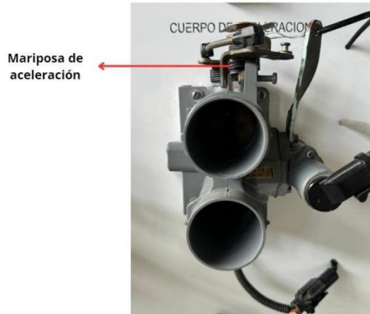
Figura 1 2 Ubicación de la mariposa de aceleración.
