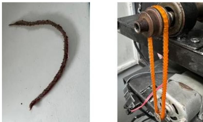
Figura 20. Antes y después correa del motor
