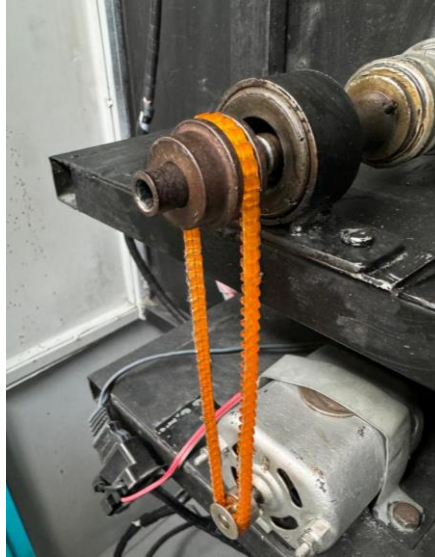
Figura 43. Riesgo de Atrapamiento en el BSIEG
