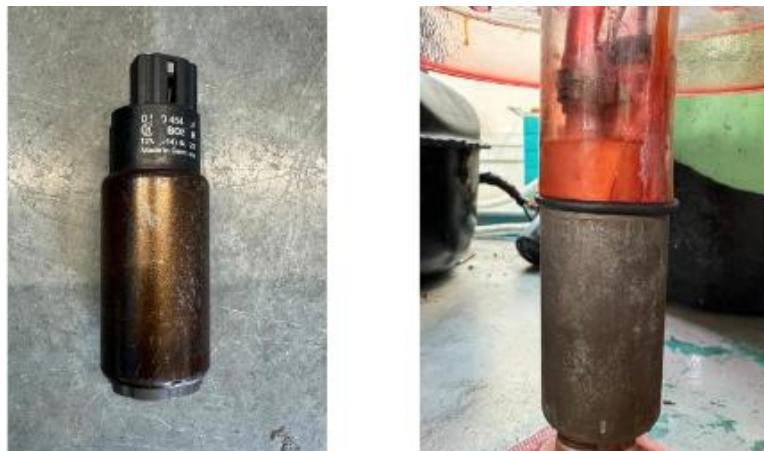
Figura 17. Antes y después bomba eléctrica de gasolina
