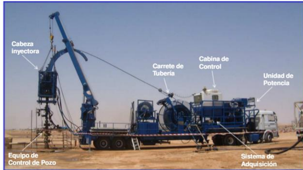
Figura 8: Componentes principales de una unidad de CT.
