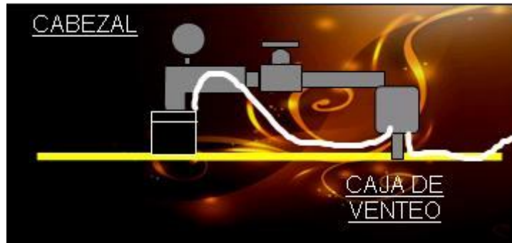
Figura 11. Cabezal de descarga y caja de venteo
