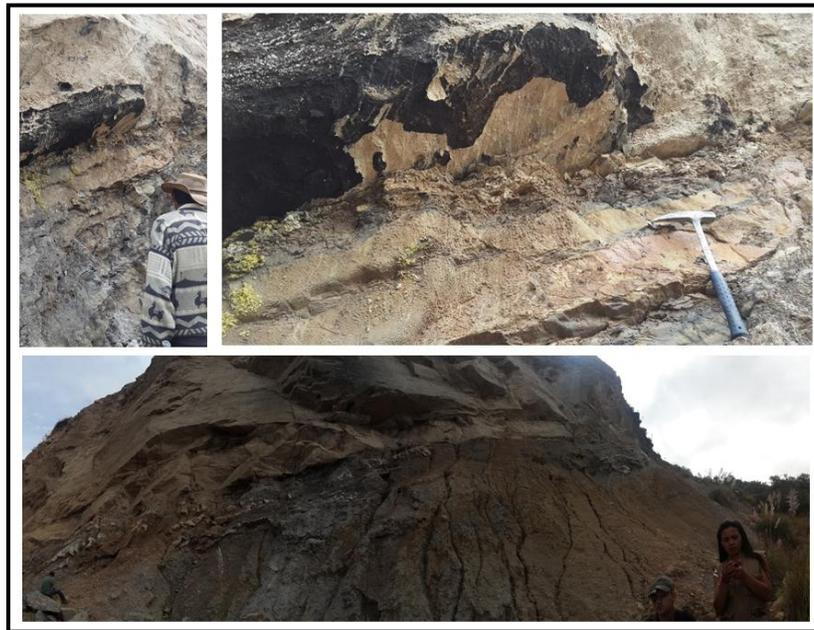
En la **Figura 20** se observa el afloramiento y el detalle de una de las capas con alta impregnación. Las condiciones del terreno en la parte superior del afloramiento no permitieron llevar a cabo la adquisición de ningún sondeo, considerando que la apertura máxima que podía realizarse era de  $AB/2$  igual 10 metros y por lo tanto la profundidad de alcance iba a hacer insuficiente para analizar la respuesta de las arenas bituminosas.
