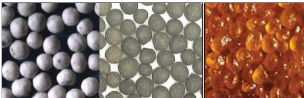
Figura 4 Granos de la arena de izquierda a derecha ISP, LWCP y RCS respectivamente.
