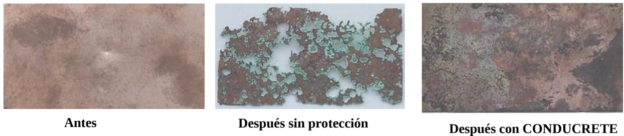
Figura 20 Comparación de muestra de cobre sin protección vs protegida con CONDUCTRETE. Adaptado de: SAE, Soluciones innovadoras sistemas de tierras físicas, «SAE,» Recuperado de: https://www.saeinc.com/ .
