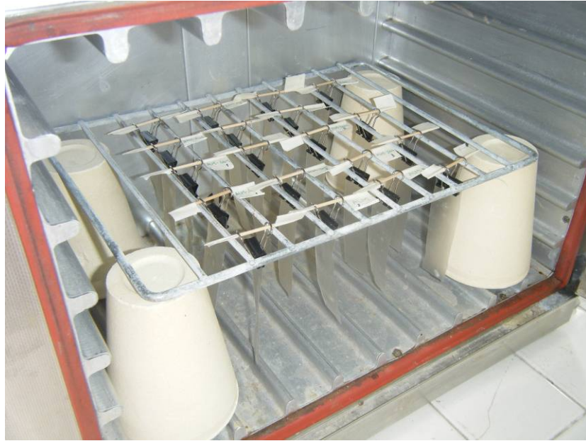
Figura 25. Disposición de las películas en el horno para su acondicionamiento inicial.
