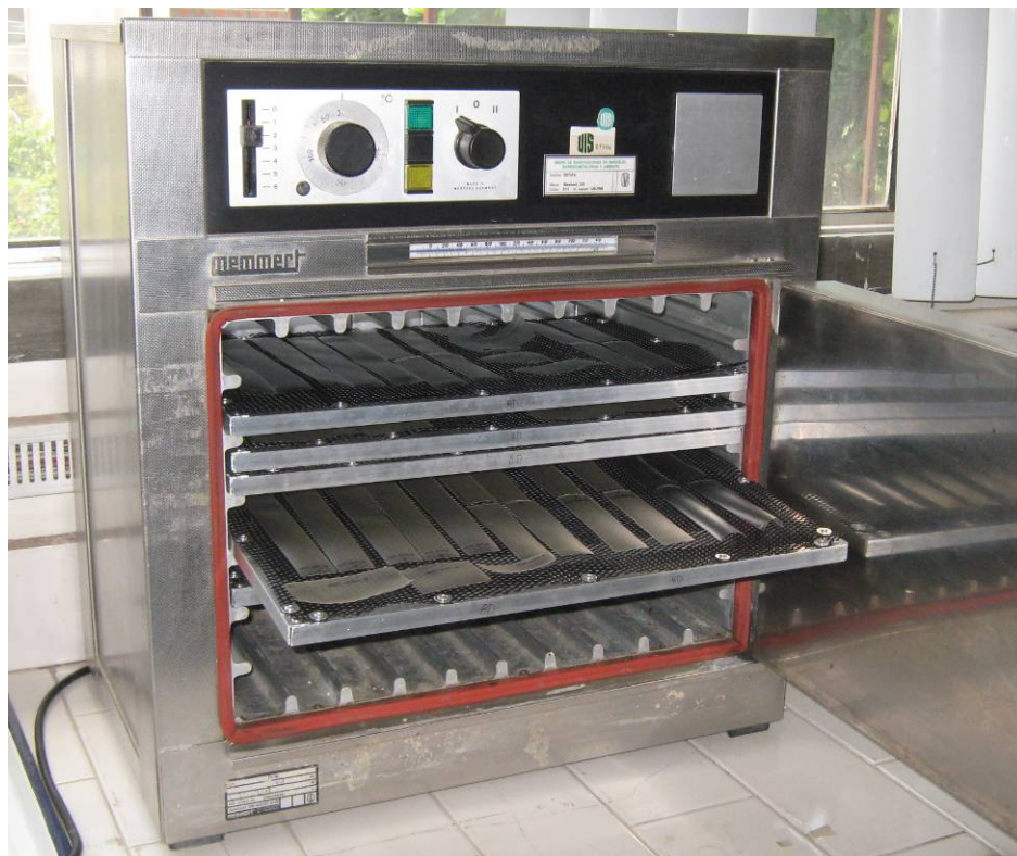
Figura 28. Disposición de las películas en horno para su envejecimiento térmico.
