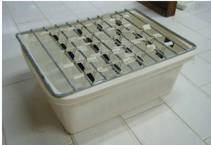
Figura 26. Películas suspendidas y sumergidas en agua.
