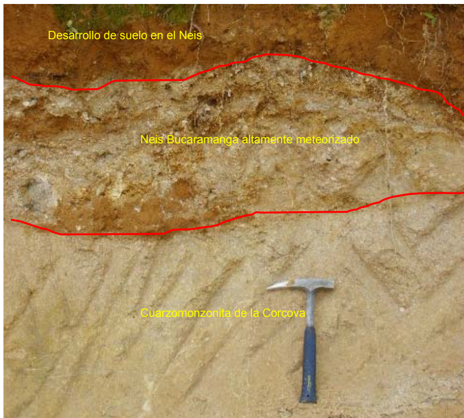
Figura 38. Cuarzomonzonita de la Corcova (colores claros en la parte inferior) en contacto con el Neis de Bucaramanga. Se observa la meteorización moderada y el desarrollo de suelo en el neis. Foto tomada en los carreteables que conducen de la Vereda Casiano a Alsacia.
