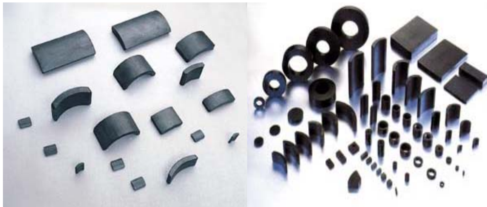
Figura 2. Imanes de ferrita de bario y estroncio
