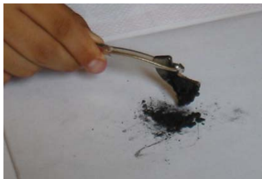
Foto B. Imán de Neodimio atrayendo grafito magnético de la mezcla 45/45/10*
