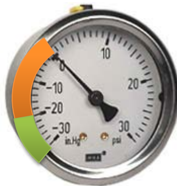
Fig. 38 Zonas de operación en vacío.
