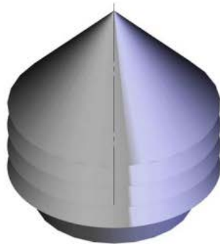
Sombrerete Estándar Tipo B - NTC 3567 Diámetro Nominal 5" Acero Galvanizado Calibre 20
