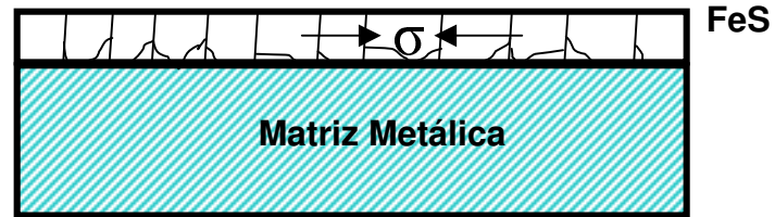
Figura 7.14 Desarrollo de esfuerzos en la capa de sulfuro formada sobre la superficie del acero ferrítico Fe-9Cr-1Mo Modificado.
