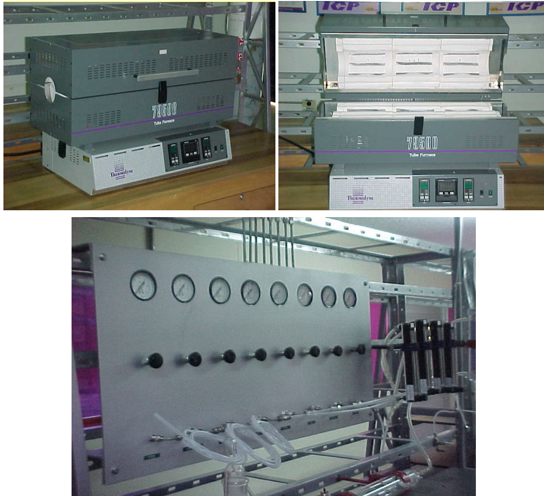
Figura 6.47 Horno Thermolyne 79500 utilizado para oxidación-carburación-sulfidación, con su tablero para suministro de gases.
