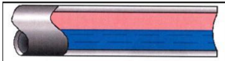
Figura 3. Flujo tipo estratificado.
