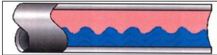
Figura 4. Flujo tipo ondulado
