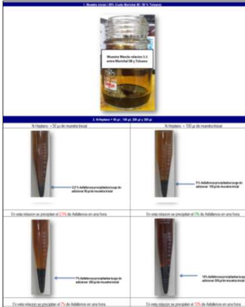
Figura 13. Asfáltenos precipitados durante las pruebas de screening test
