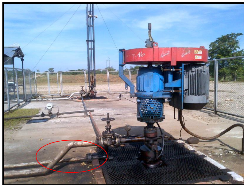
Foto 7. Conexión amulares de los pozos T-522 y T-523.
