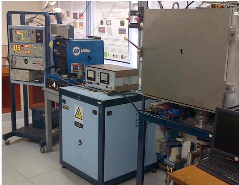
Figura 13. Reactor MOSMET: (1) Cámara de descargas, (2) Sistema de vacío, (3) Fuente de alto voltaje, (4) Panel de encendido descarga de arco, (5) Fuente para el arco eléctrico, (6) Panel de control general.
