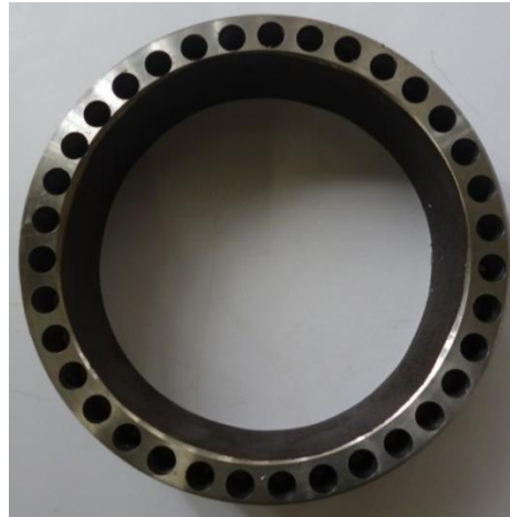
Figura 40. Anillo de API SPECT 5CT P110 perforado.
