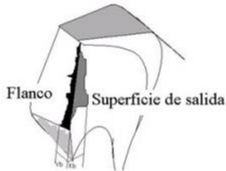
Figura 3. Desgaste de cráter y flanco presente en una broca.
