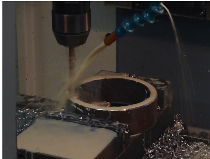
Figura 39. Perforación de anillos de API SPECT 5CT P110.
