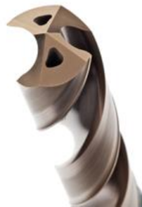
Figura 8. Broca con canales de refrigeración.
