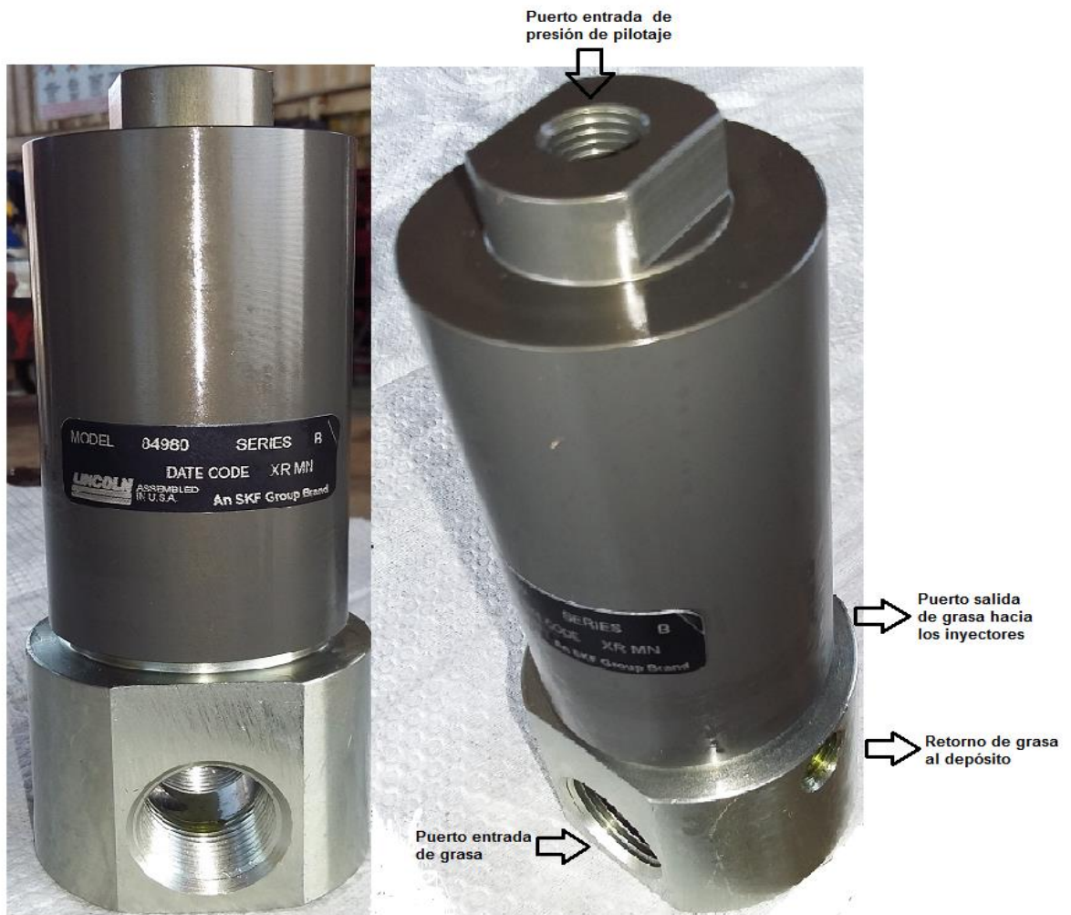
Figura 20. Ilustración de la válvula de venteo
