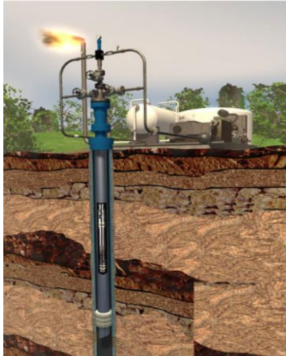
Figura 11. Representación gráfica de un pozo con bombeo hidráulico.
