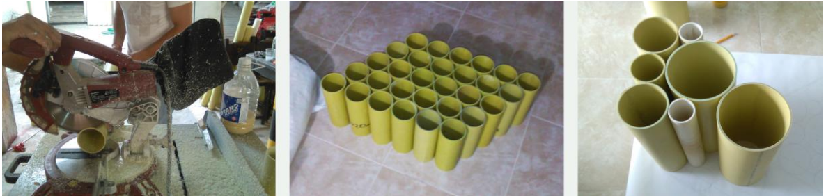
Figura 103. Proceso de corte de tubería.
