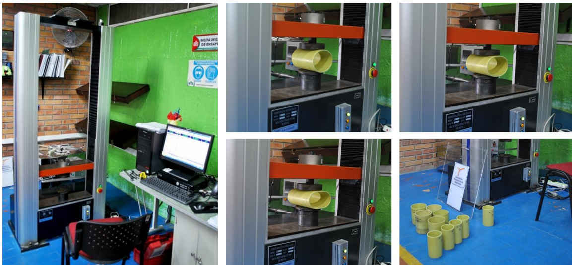
Figura 23. Máquina MCM universal de ensayos / ensayo a compresión “eje perpendicular”
