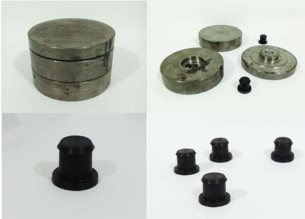
Figura 56. Molde y Prototipo unión: pasador.
