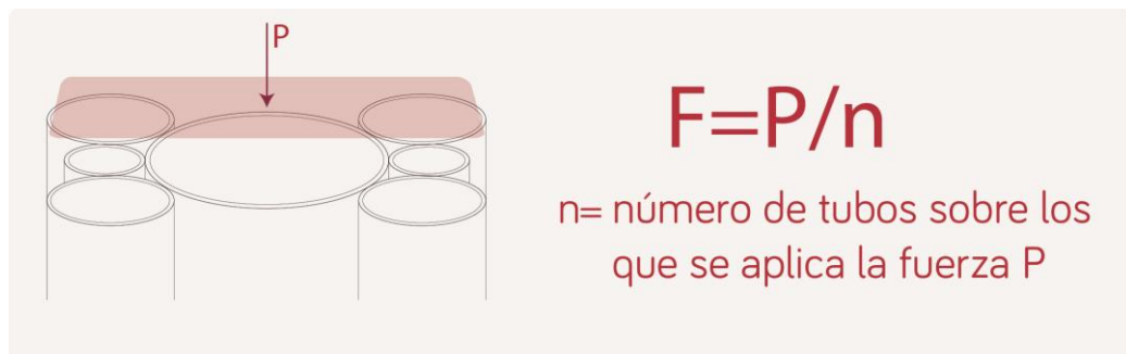
Figura 49. Fuerza para el cálculo de esfuerzo cortante en la unión pasador.
