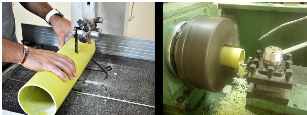
Figura 20. Corte y preparación de probetas para ensayos mecánicos
