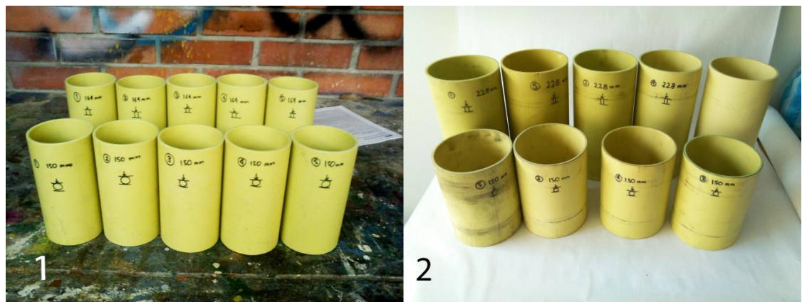
Figura 22. (1) Probetas para compresión diámetro 1---(2) Probetas para compresión diámetro 2
