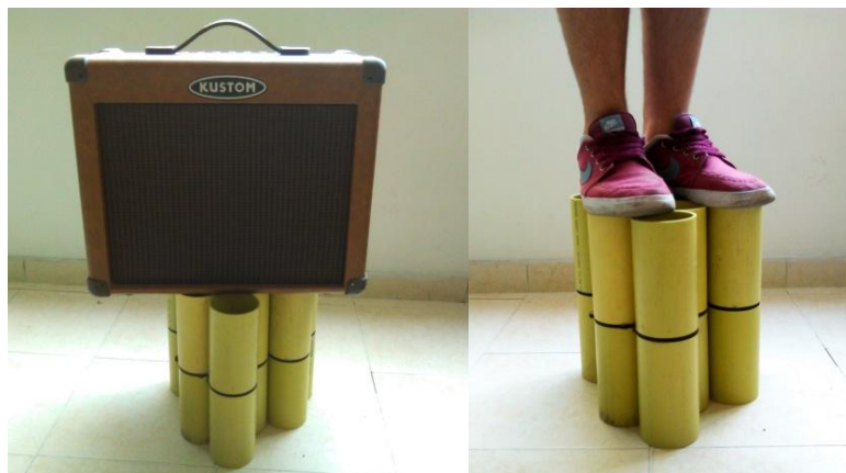
Figura 45. Aplicación de cargas al ensamblaje: Elemento de unión-Tubería.
