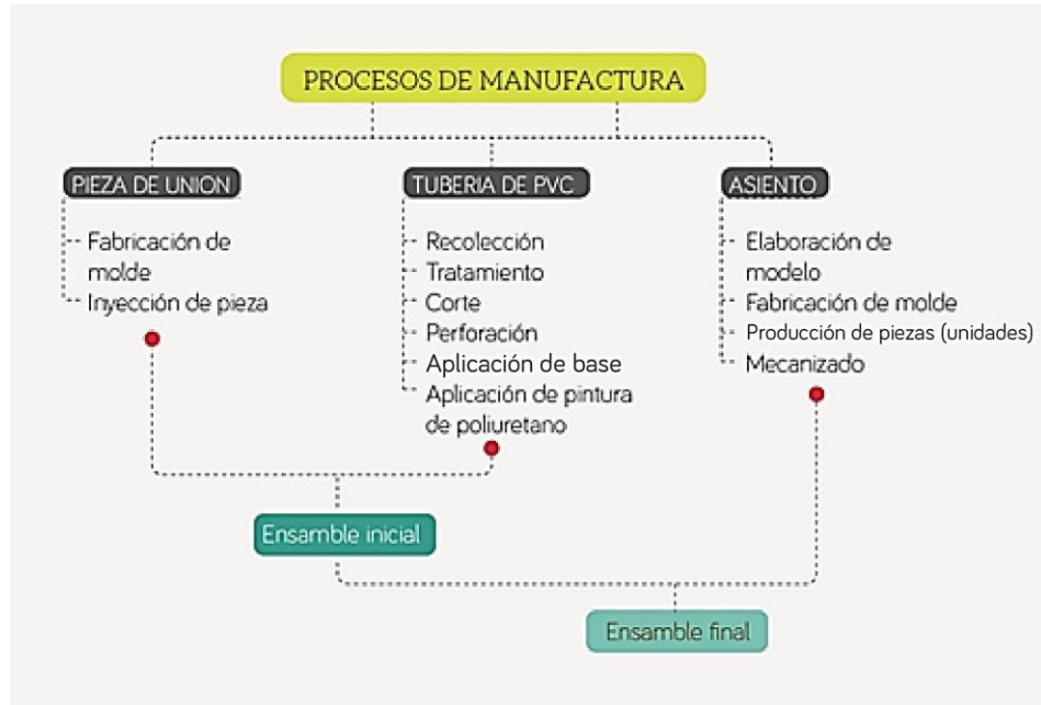
Figura 93. Proceso de manufactura para elementos de mobiliario.
