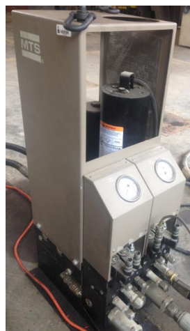
Figura 4: Unidad de acumulador.
