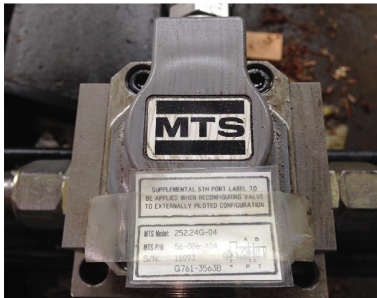
Figura 10: servoválvula MTS serie 252.
