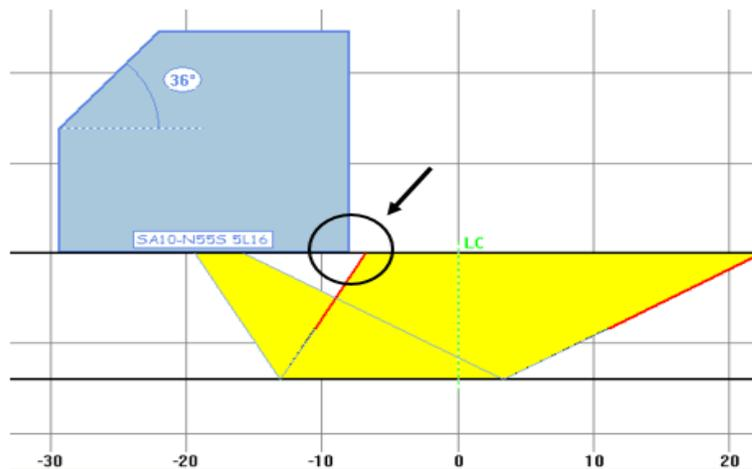
**4.1.3 DISEÑO DE LAS MUESTRAS.** Una vez determinadas las dimensiones externas de las muestras, se finalizó el diseño con la distribución de las discontinuidades, de tal forma que en cada muestra se mecanizó una discontinuidad siguiendo el diseño de experimentos. El largo de las muestras en la cual se mecanizó una discontinuidad con inclinación de  $55^\circ$  (Muestras M1, M3, M4 y M6) fue de 200 [mm], permitiendo el acople del palpador por los dos lados (figura 14a y
