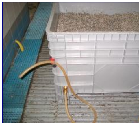
b. Sistema de Recogida del Efluente
