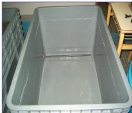
a. Contenedor plástico con sistema de recogida del efluente
