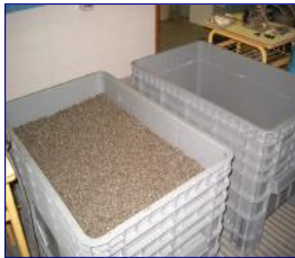
b. Llenado de los contenedores con grava
