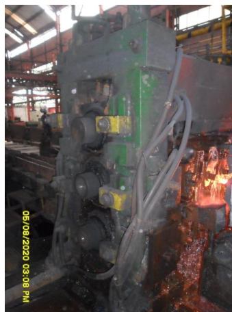
Figura 10. Tren 350/450 o tren de desbaste.
