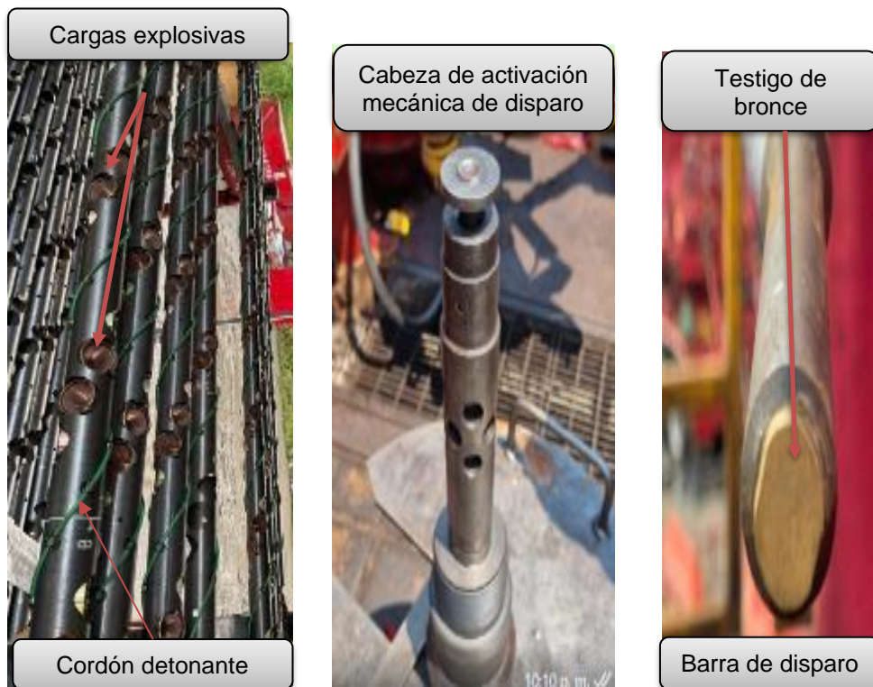
Figura 8. Fotografías de componentes de sarta TCP 12
