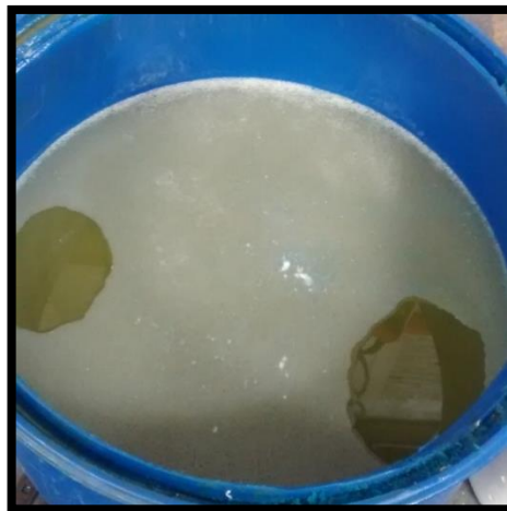
Figura 6. KLEANEX DEC AC12-LE usado en la etapa de decapado de las piezas a galvanizar.
