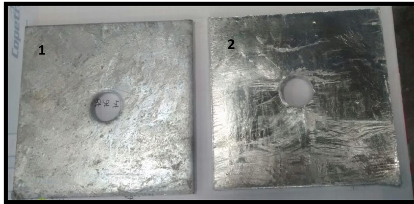
Figura 16. Arandelas galvanizadas. (1) por centrifugado. (2) por inmersión.
