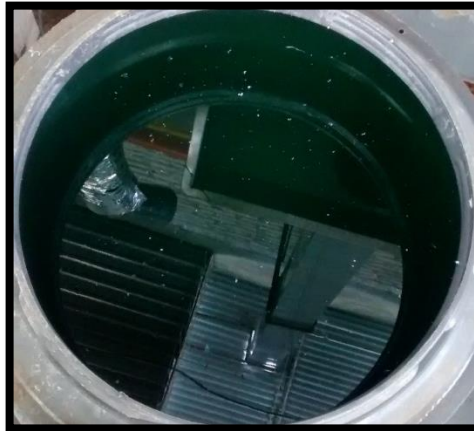
Figura 7. Flux BYC Zn-5 usado en la preparación de las piezas a galvanizar.
