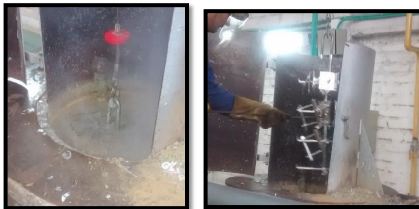
Figura 11. Etapa de galvanizado por inmersión. (a) entrada en el baño del cinc. (b) salida del baño de cinc.
