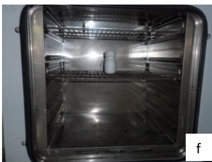
Figura 11. a) mezcla de NaOH con el material de partida; b) fusión NaOH/material de partida; c) agitación magnética del gel de reacción; d) envejecimiento estático e) envejecimiento ultrasonido f) calentamiento del gel de reacción; g) filtración del producto sintético; h) producto final después del secado
