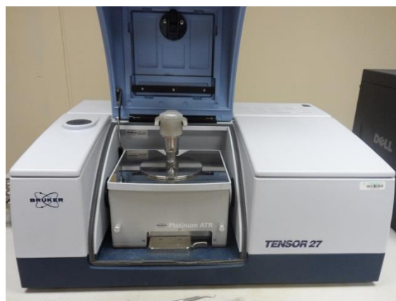
Figura 9. Espectrómetro marca BRUKER TENSOR 27 a 20 ° C utilizando una celda PLATINUM BRUKER ATR
