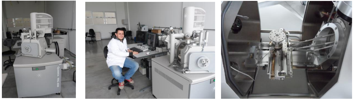
Figura 7: Microscopio electrónico de barrido Quanta 650 FEG SEM que utiliza la tecnología de emisión de campo (Schotty Field EmissionGun)
