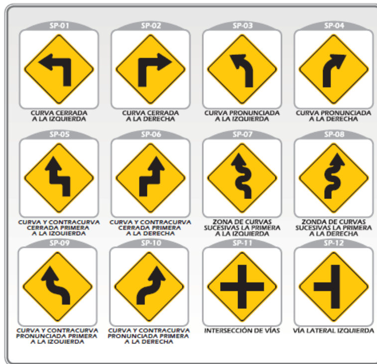
Figura 3. Señales verticales preventivas.
