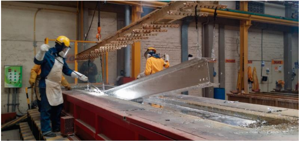
Figura 8. Proceso de galvanizado realizado por GARCÍA VEGA S.A.S.
