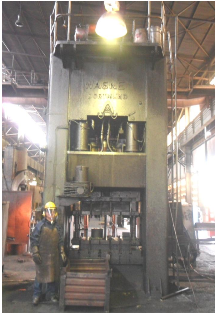
Figura 1. Prensa de 500 Toneladas para forja en caliente
