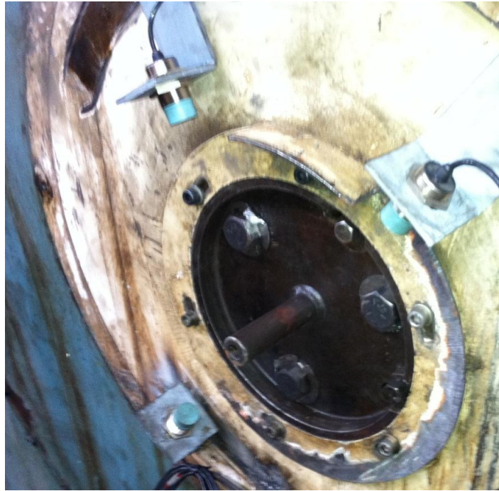
Figura 68. Sensores inductivos para detección de proximidad del resalto.
