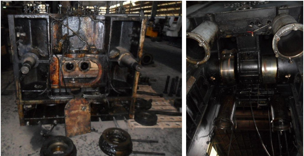
Figura 6. Porta-útil desmontado y desarmado
