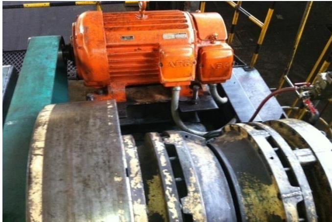
Figura. Transmisión de movimiento entre el motor y el embrague.
