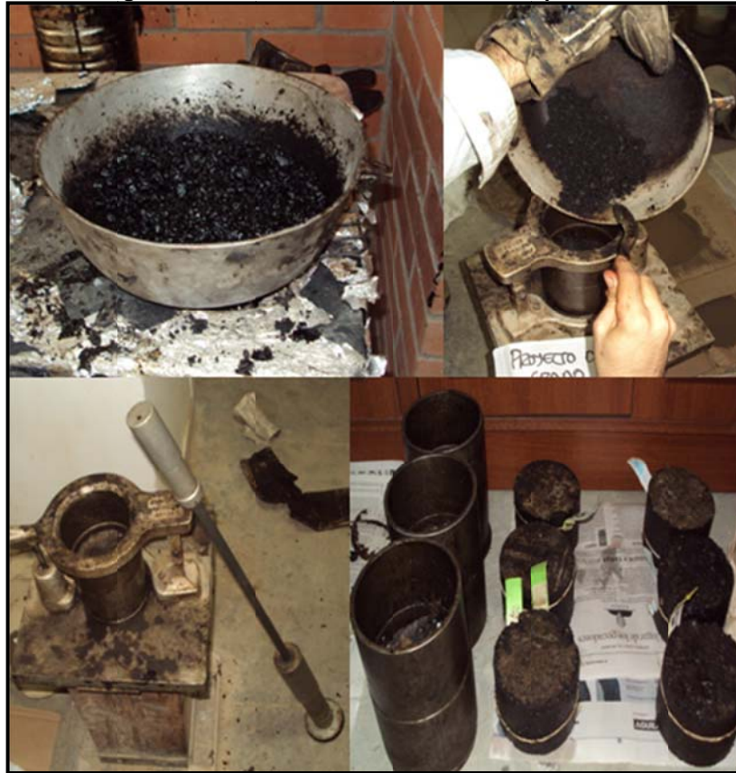
Figura 3-4. Proceso de elaboración de las probetas.
