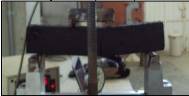
Figura 2-12. Ensayo de flexión pura.
