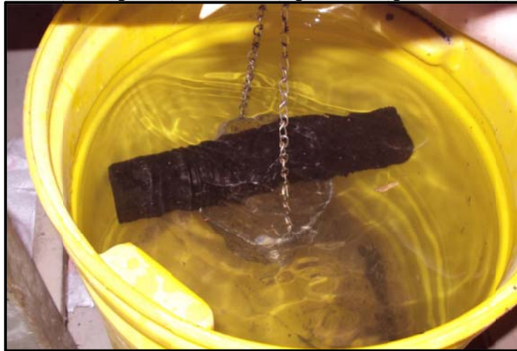
Figura 2-6. Peso sumergido a las vigas.
