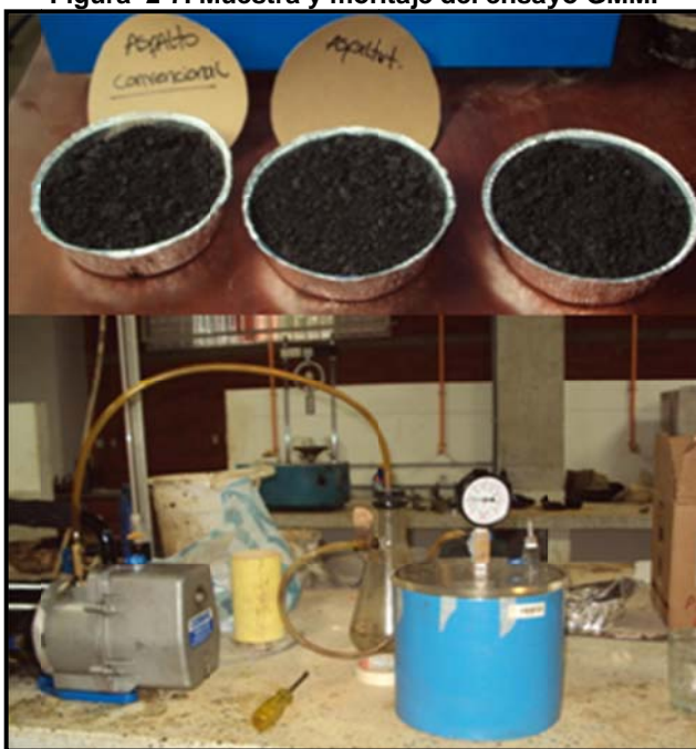
Figura 2-7. Muestra y montaje del ensayo GMM.
