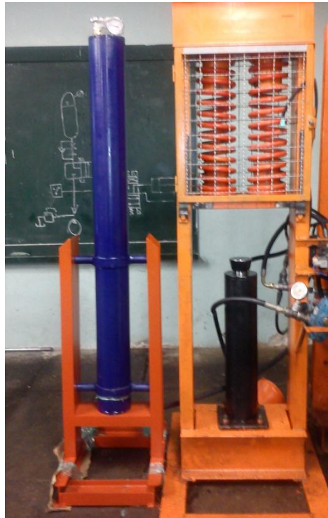
Figura 93 Montaje acumulador y cilindro hidráulico Referencia autores del proyecto
