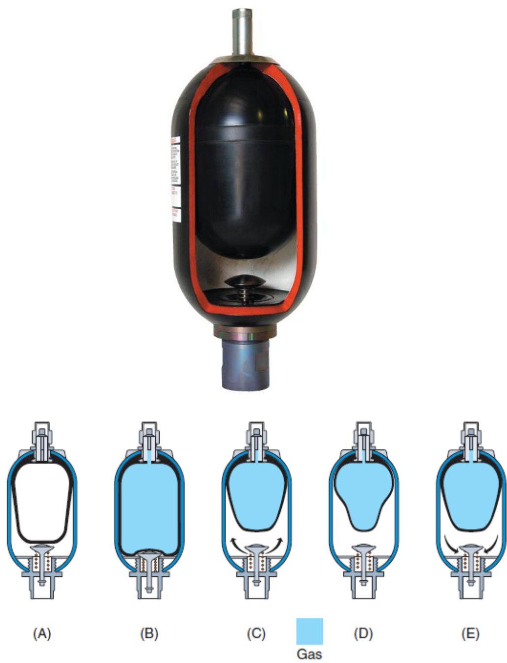
Figura 103 Funcionamiento del acumulador tipo vejiga Referencia OLAER
