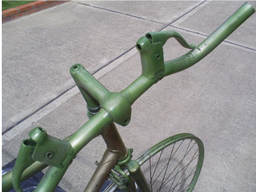
Proceso de pintado de la bicicleta. Se aplica una base antioxidante.
