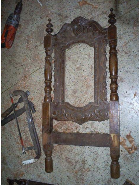
Proceso de desarme de la silla por un maestro carpintero
