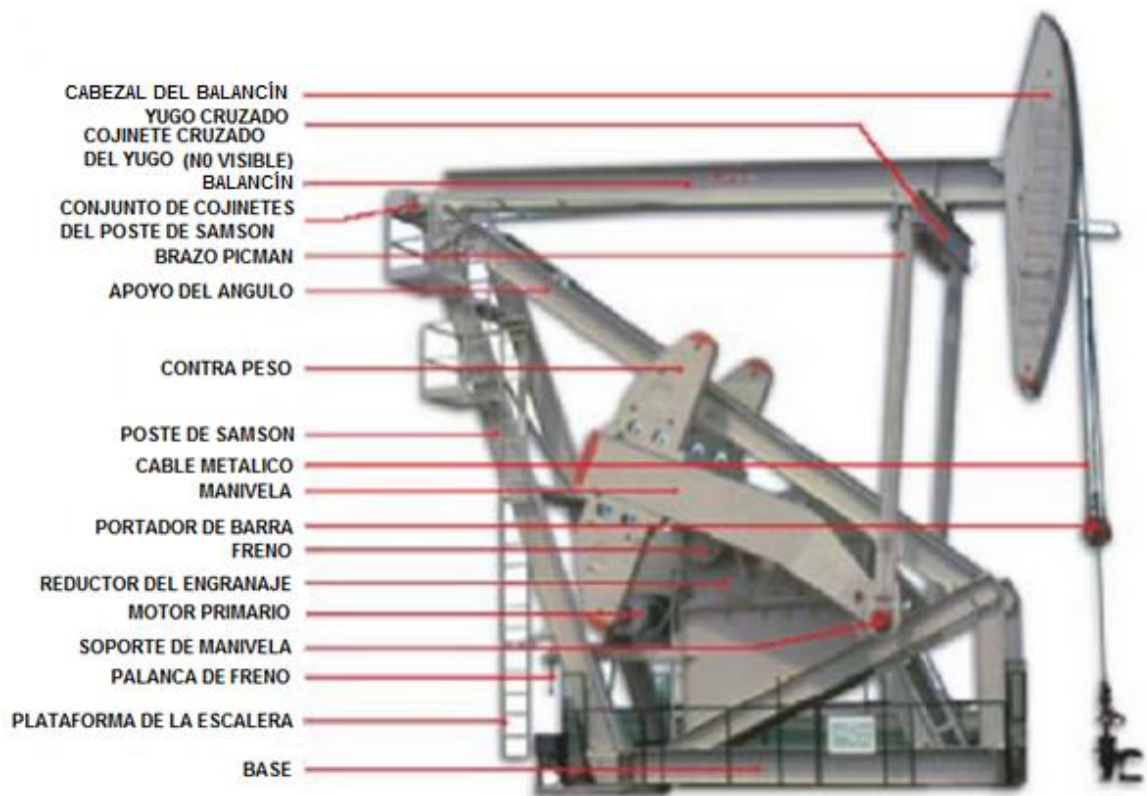
Figura 13. Nomenclatura de la Unidad de Bombeo Mark II.
