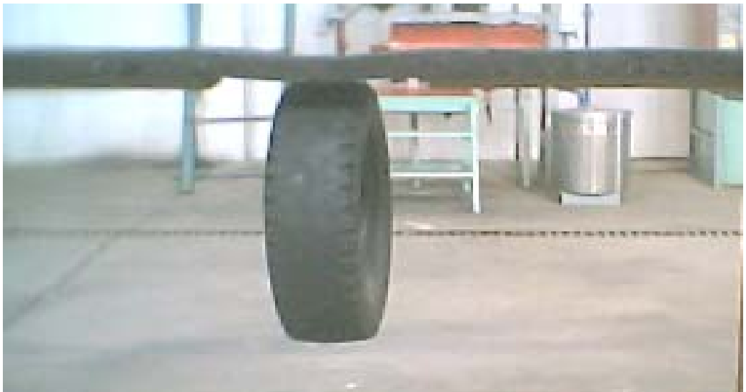
Foto 8. Ensayo de adhesión con una llanta de moto cuyas dimensiones son 37.5 cm de diámetro y 9 cm de ancho.
