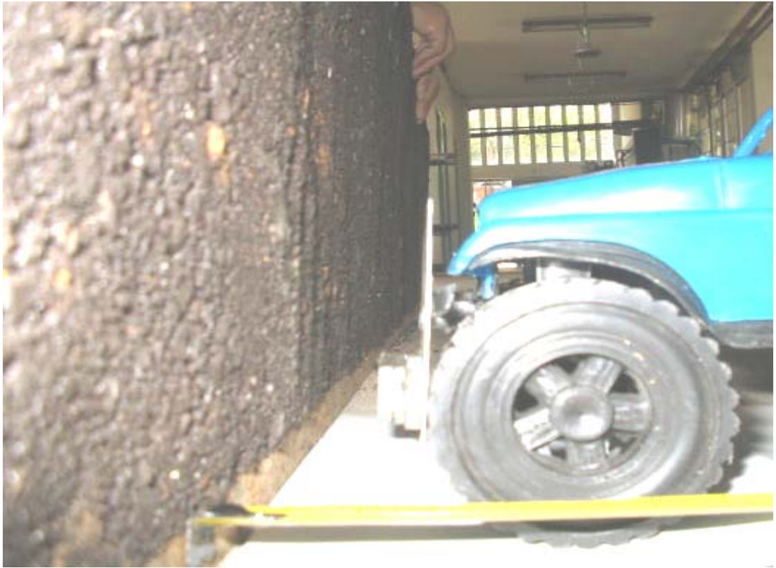
Foto 4. Ensayo para determinar la distancia máxima donde comienza la atracción entre las dos superficies (PF-IMANES), debido al campo magnético.
