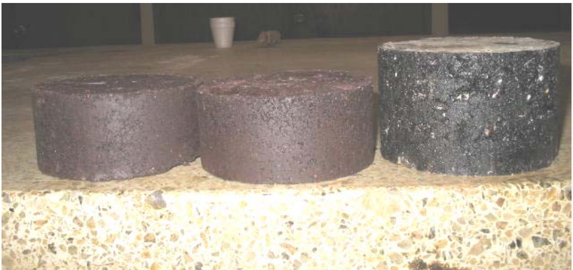
Foto 2. Probetas realizadas para determinar el contenido óptimo de asfalto y determinar propiedades
