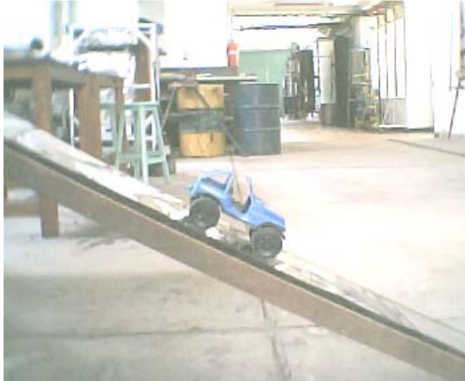
Foto 6. Vista de prueba de velocidad en el pavimento ferromagnético con un ángulo de inclinación
