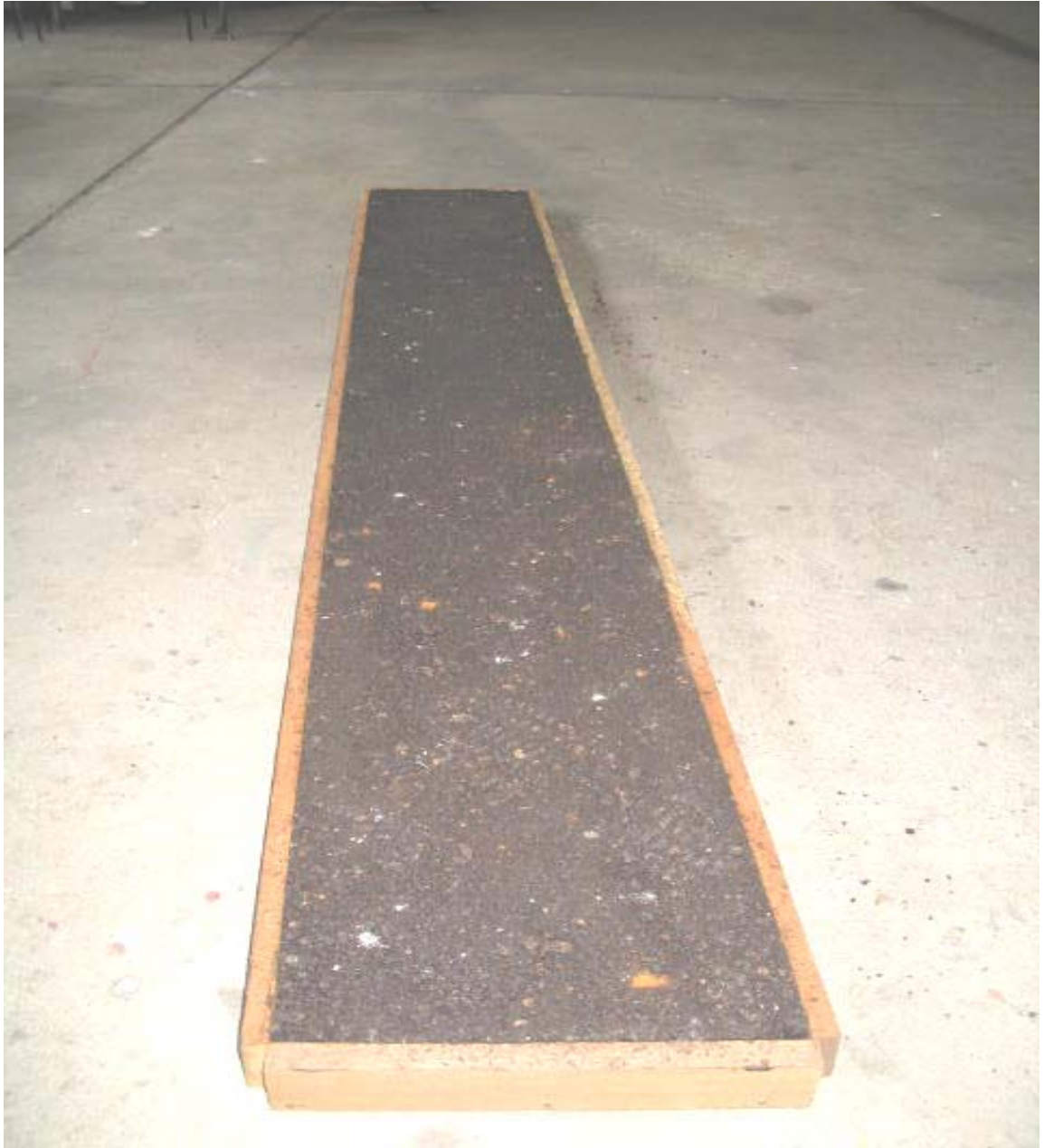
Foto 3. Placa de pavimento ferromagnético hecha utilizando el método de Bruce Marshall de dimensiones Largo: 200 cm; Ancho: 28 cm; Alto: 3 cm
