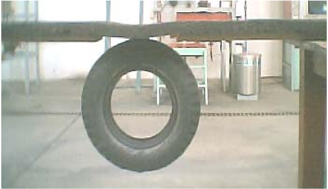
Foto 7. Ensayo de adhesión entre las superficies PF-LLM con la llanta suspendida
