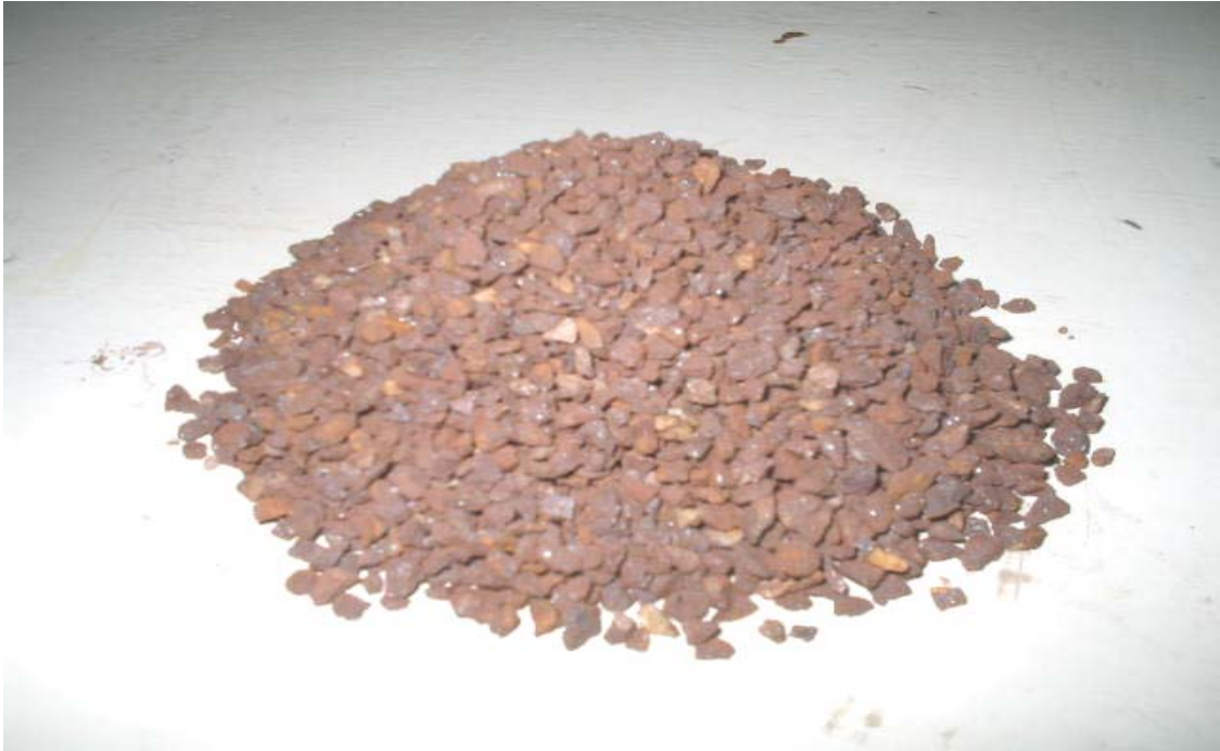
Foto 1. Roca imán triturada utilizada como agregado para la mezcla asfáltica en caliente
