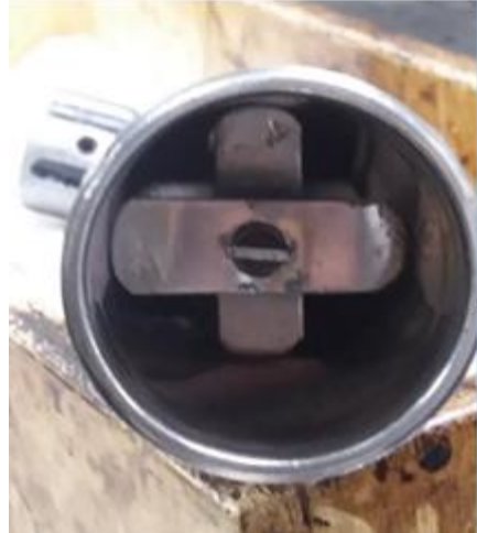
Figura 9. Bala de corrosión utilizada en la experimentación del desasfaltado de slurry .
