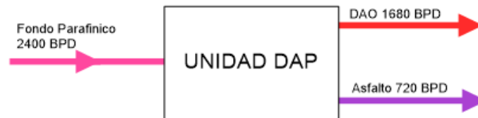
Figura 3. Diagrama entradas-salidas del proceso de desasfaltado con propano (DAP), unidad U-1000.
