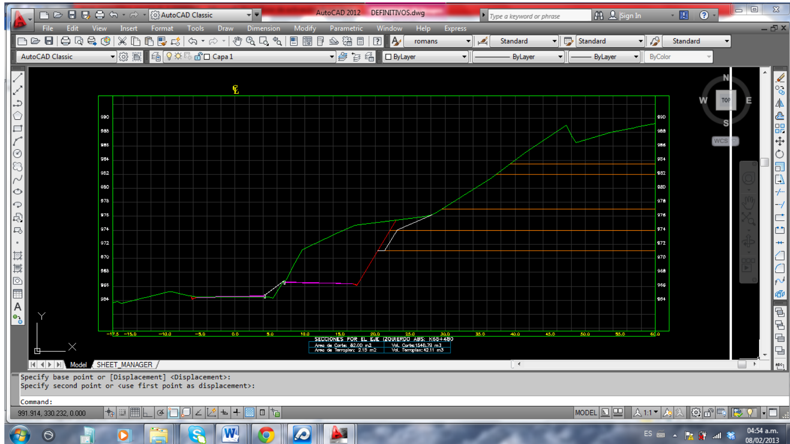
Fotografía 27: Modelo digital del talud en situación pasada, presente y futura
