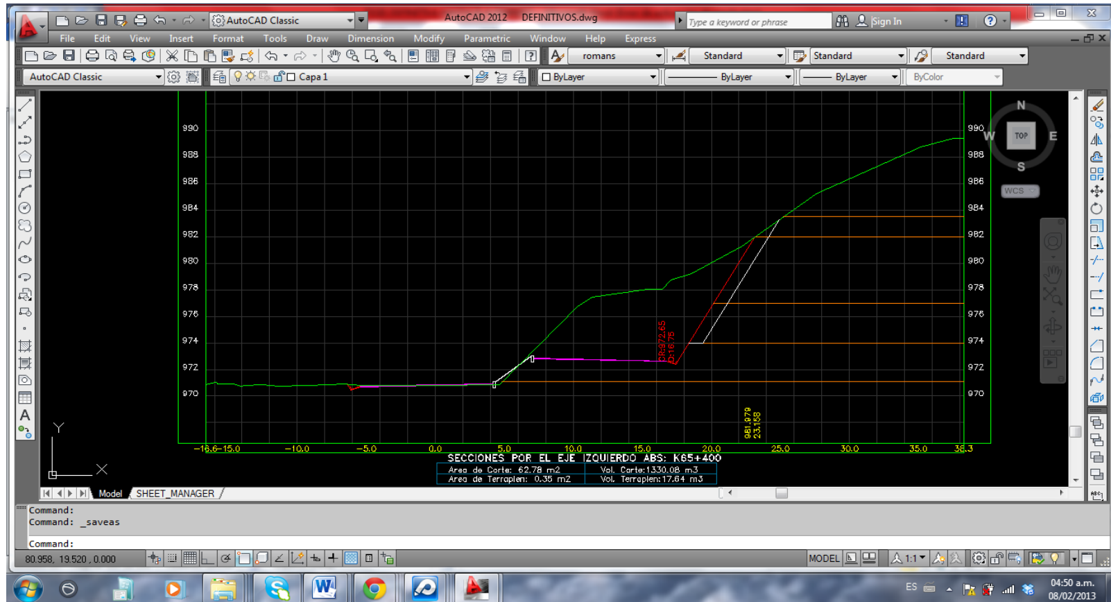
Fotografía 23: Modelo digital del talud en situación pasada, presente y futura.
