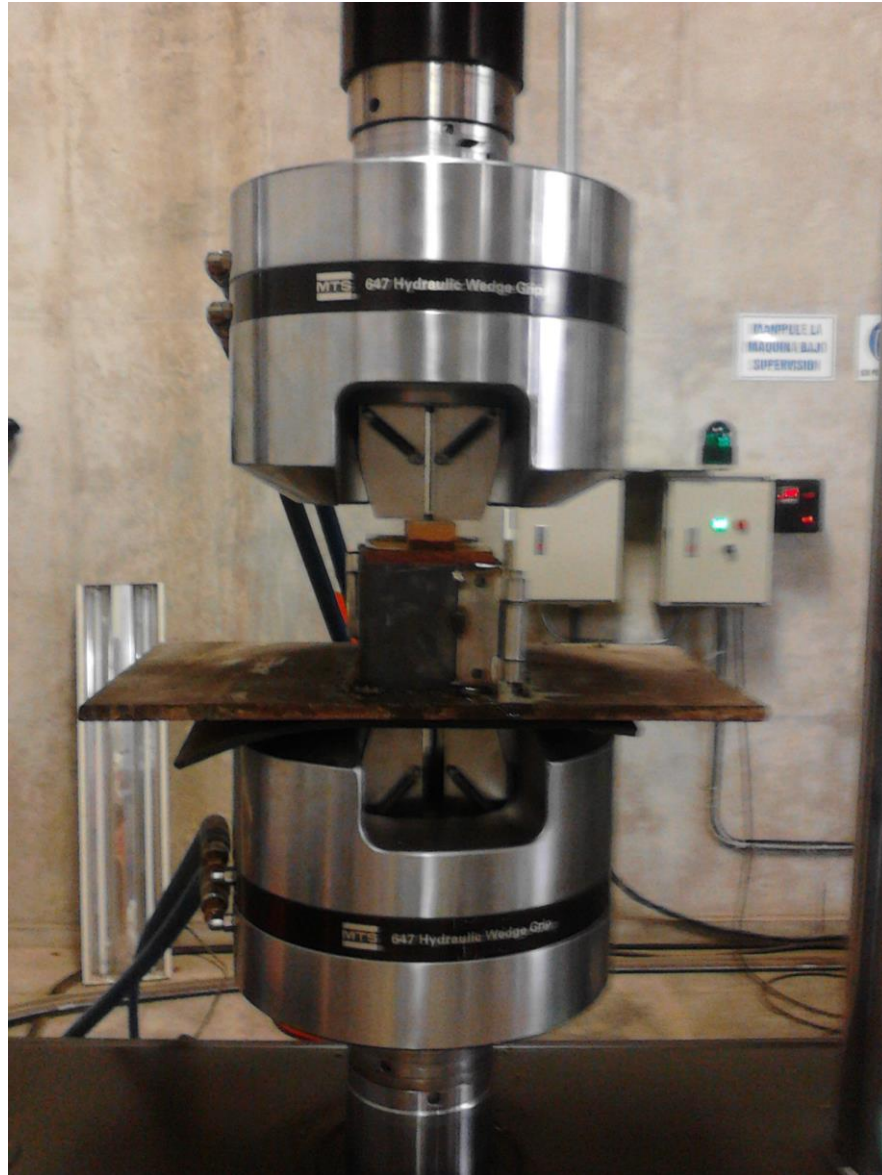
Imagen 2. Compresión del adoquín por medio maquina MTS 810
