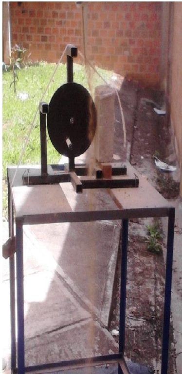
Imagen 6. Ensayo de abrasión realizado en máquina artesanal.
