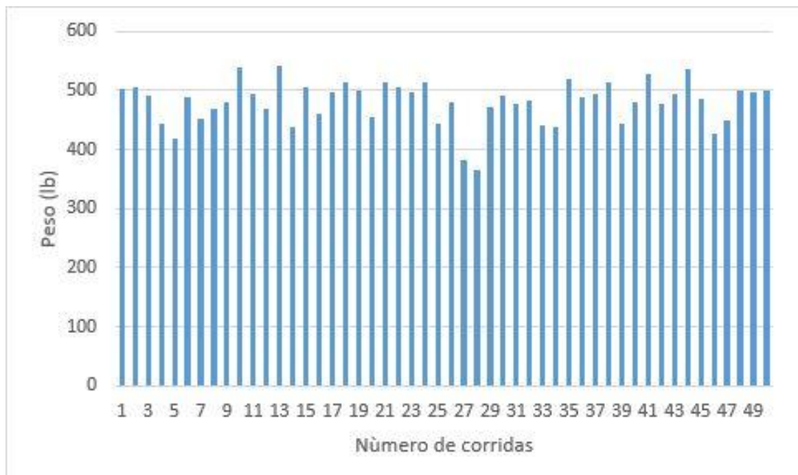
Ilustración 24. PSO, peso por corrida armadura de 72 elementos.
