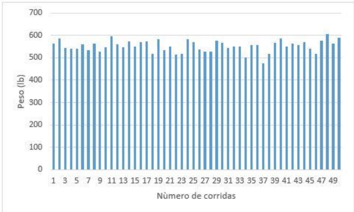
Ilustración 19. PSO, peso por corrida armadura de 25 elementos.
