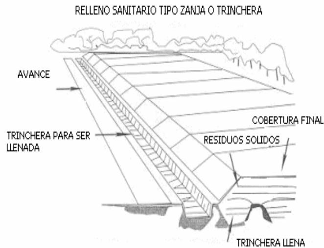
Figura 3. Relleno Sanitario Tipo Zanja o Trinchera 3
