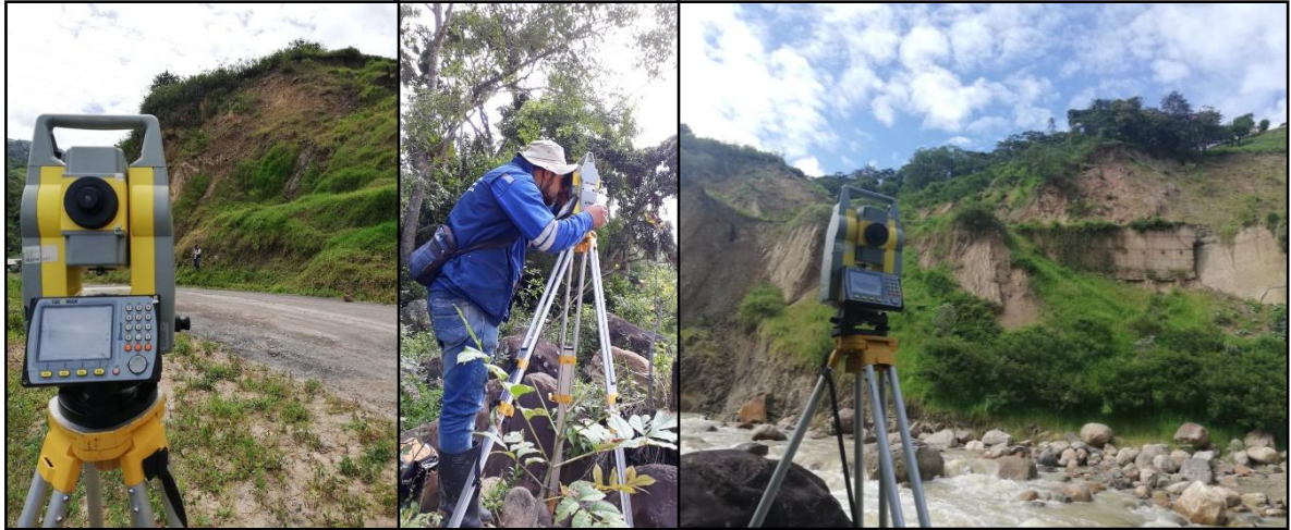
Figura 32. Levantamiento topográfico en el talud de estudio
