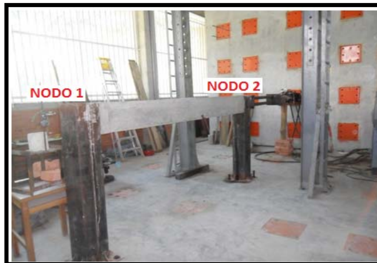
Fotografía 6.11 Fotografía en la que se ilustra el Actuador MTS aplicando carga estática incremental en el modelo a escala.
