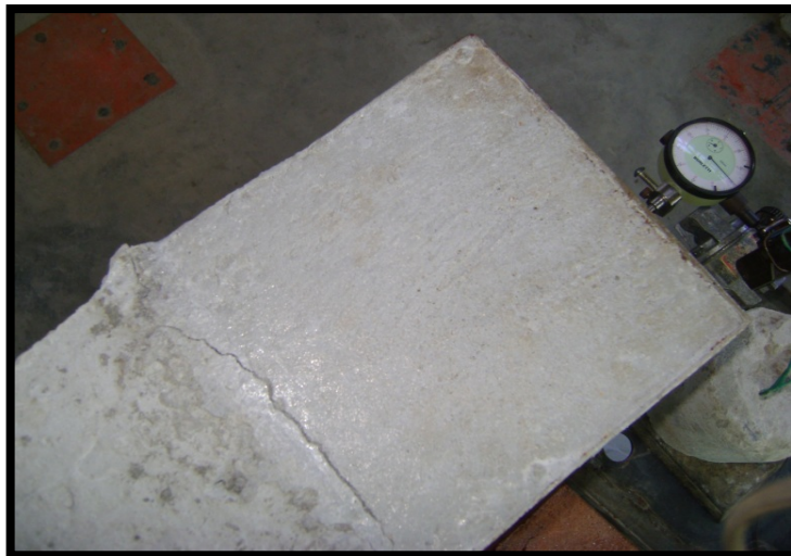
Fotografía 6.12. Aparición de grieta en la parte superior del nodo 1
