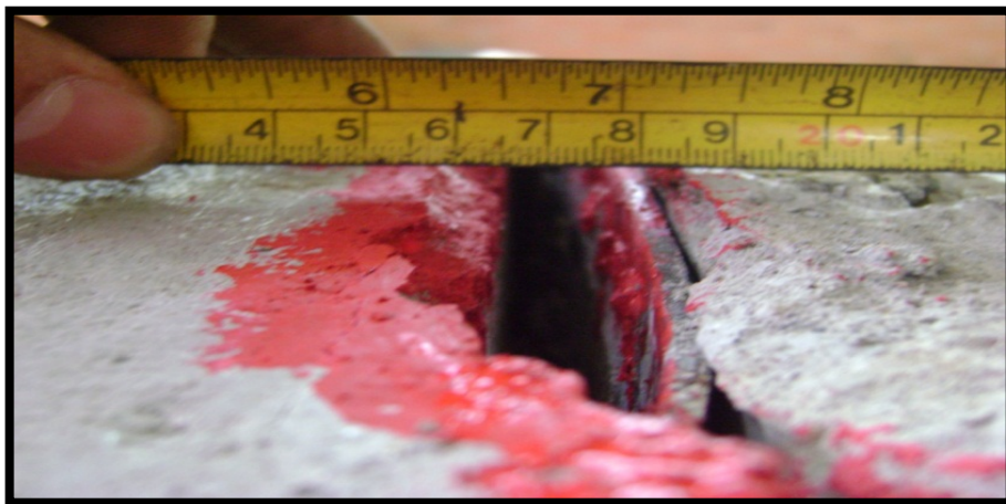
Fotografía 6.13. Vista superior del nodo 1 después de aplicada la carga
