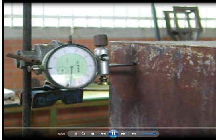
Fotografía 6.10 Instalación de un deformímetro en la parte superior del pórtico
