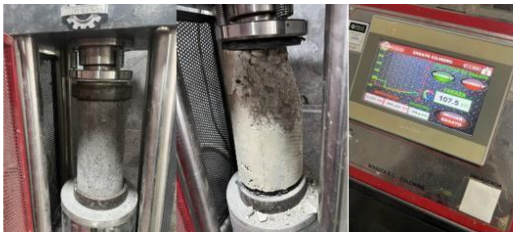
Figura 28: Fotografía de cilindros fallados. Nota: Autor
