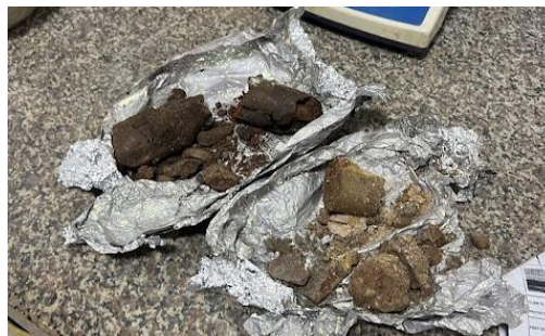
Figura 14:Fotografía del cuarteo de la muestra. Nota: autor
