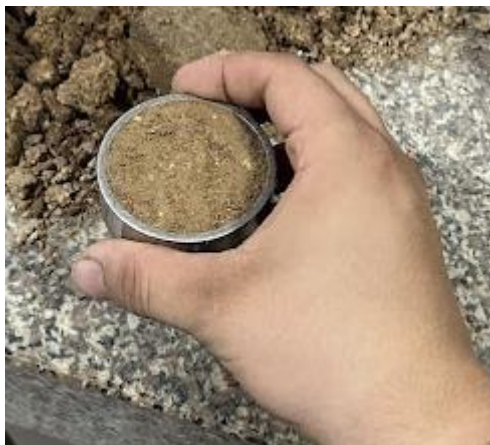
Figura 22:Fotografía de pastilla para corte directo. Nota: Autor
