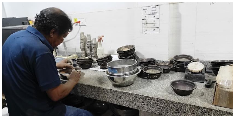
Figura 18:Fotografía de ensayo de límites. Nota: Autor
