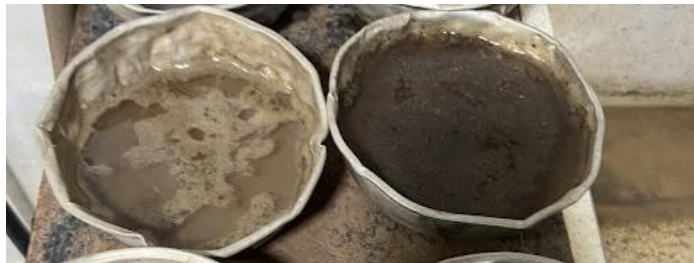
Figura 15: Remojo de la muestra para su lavado. Nota: autor
