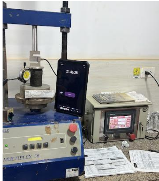
Figura 27:Fotografía al terminar el ensayo de compresión incofinada. Nota: Autor
