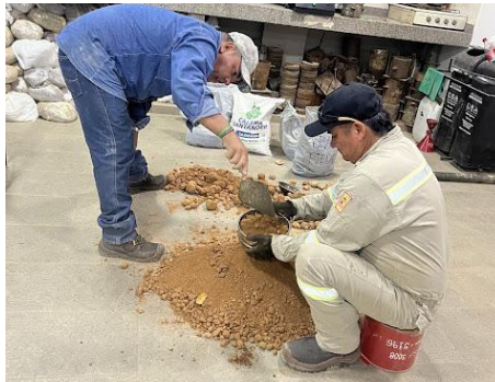
Figura 29:Fotografía granulometría material a estabilizar Nota: Autor
