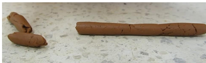
Figura 20:Fotografía de limite plástico. Nota: (Jorge Hernán Flórez Gálvez, 2020)
