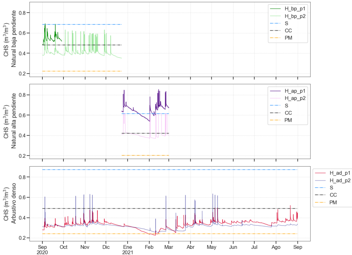
Figura A 6. Contenidos de humedad monitoreados respecto a los contenidos de humedad de la curva de retención de humedad
