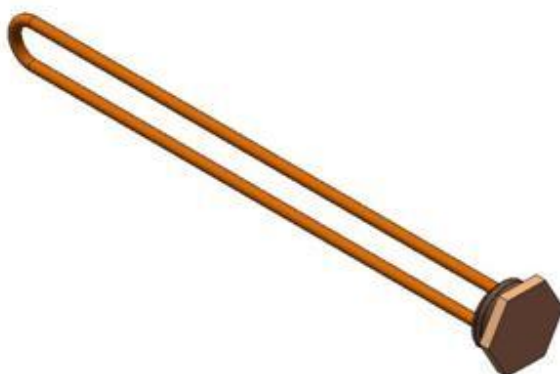
Figura 2-5. Esquema de la resistencia eléctrica.
